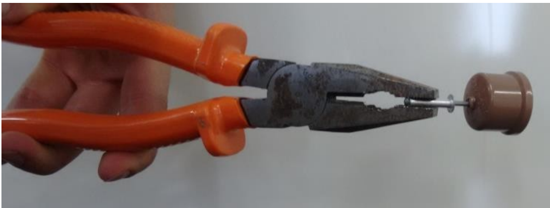
Figura 11: faça um furo com um prego ou rebite em um dos “cap” para depois, com a tesoura, abrir até a passagem justa do ventil.
