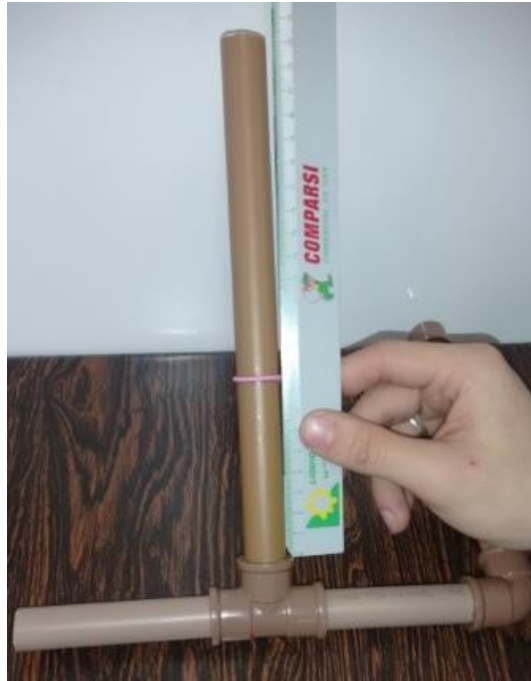
Figura 9: pegue o balão e corte apenas o anel dele, posicionando no tubo maior a uma distância de 8,5 cm do “tê”.
