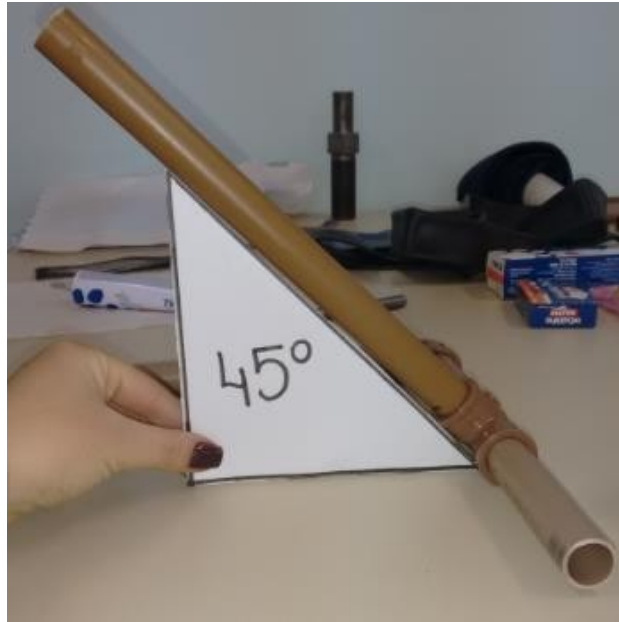
Figura 7: depois de colar os cantos, garanta um ângulo de 45° com uma face plana.
