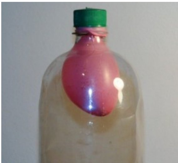
Figura 2: Balão com água para exercer a força peso.
