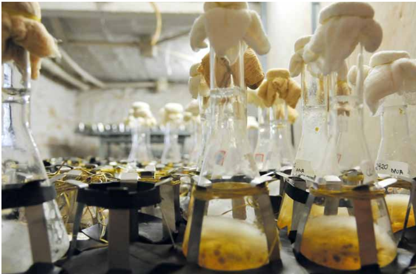
Dentre os processos desenvolvidos nas pesquisas no Instituto de Biotecnologia está a agitação mecânica do cultivo submerso de fungos
