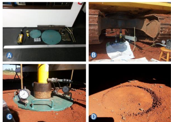
Figura 1. Ensaio de prova de carga sobre placa
