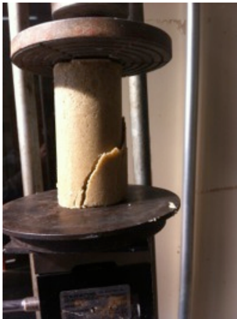
Figura 3. Ruptura do corpo de prova biocimentado.
