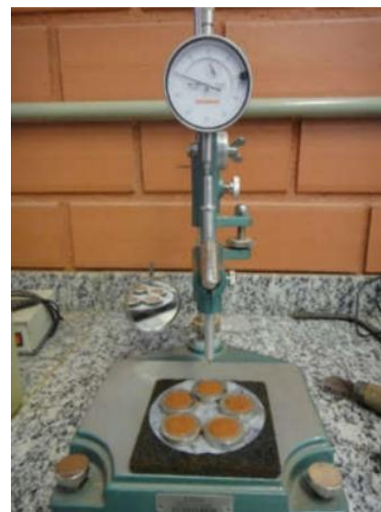
Figura 7. Pastilhas de solo e penetrômetro
