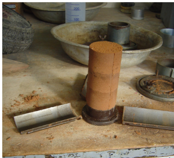
Figura 6. Moldagem de corpo de prova 50x100mm
