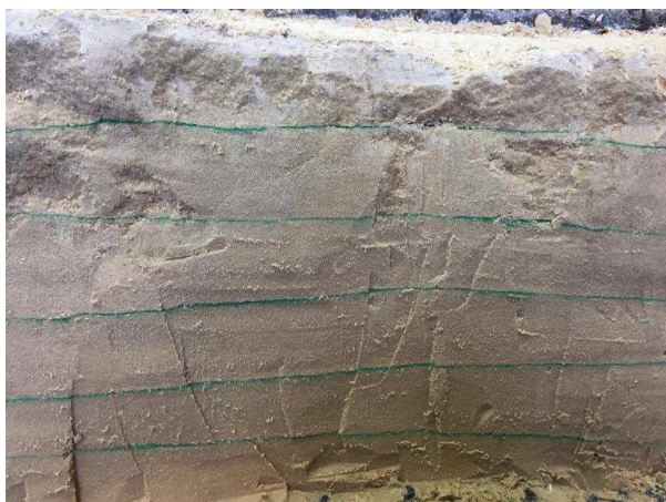
Figura 7. Biocimentação ao longo das camadas.
