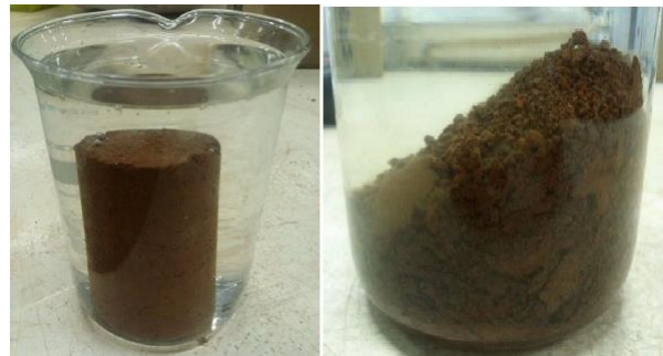
Figura 4. Corpo de prova submerso em água (Autores, 2016).
