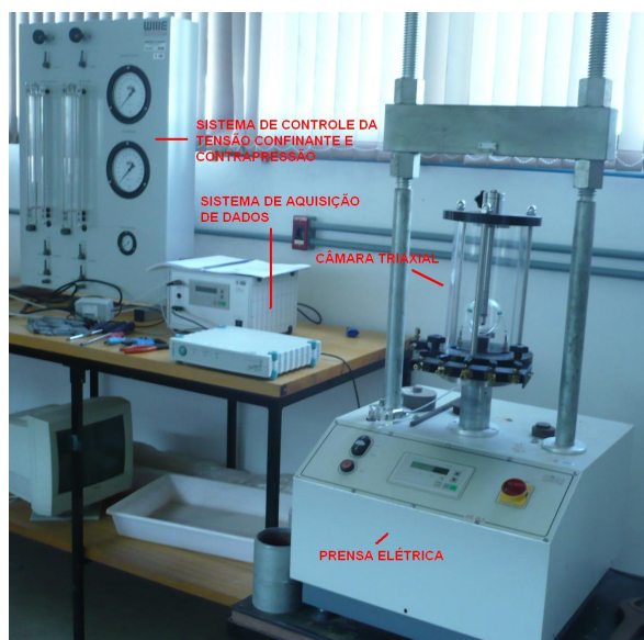
Figura 8. Arranjo experimental para os ensaios triaxiais
