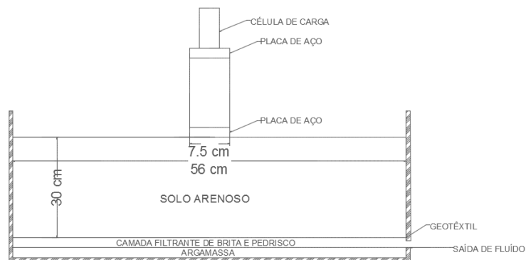
Figura 2. Corte esquemático da aplicação do ensaio de placa.
