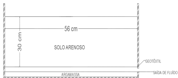
Figura 2. Corte esquemáticos dos corpos de prova.
