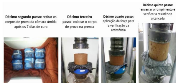
Figura 5. Rompimento corpos de prova ensaio de RCS
