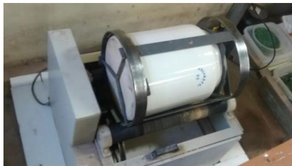
Figura 2. Moinho utilizado para moagem da cinza
