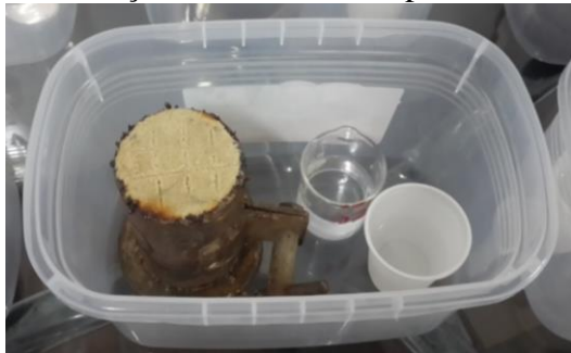
Figura 5. CP com Meio B após a finalização do ensaio de respirometria.
