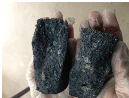
Figura 5. Corpo de prova de cinza pesada após rompimento
