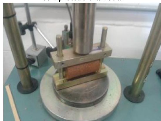
Figura 4. Ensaio de resistência à tração por compressão diametral
