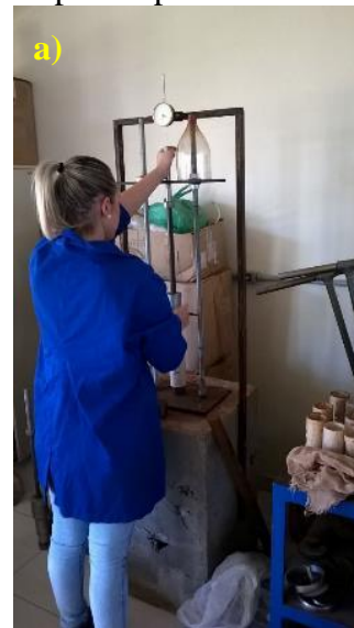
Figura 3. a) Realização da compactação MCT; b) corpos de prova em imersão
