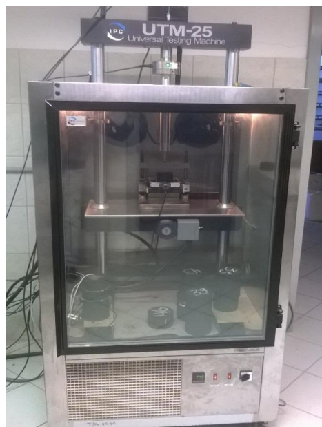
Figura 6 - Prensa UTM-25 utilizada para o ensaio de MR e E^*
