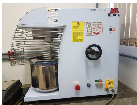
Figura 2. Misturador mecânico para preparação do solo artificial.
