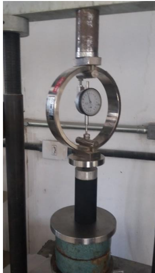
Figura 2. Ensaio de resistência à compressão simples
