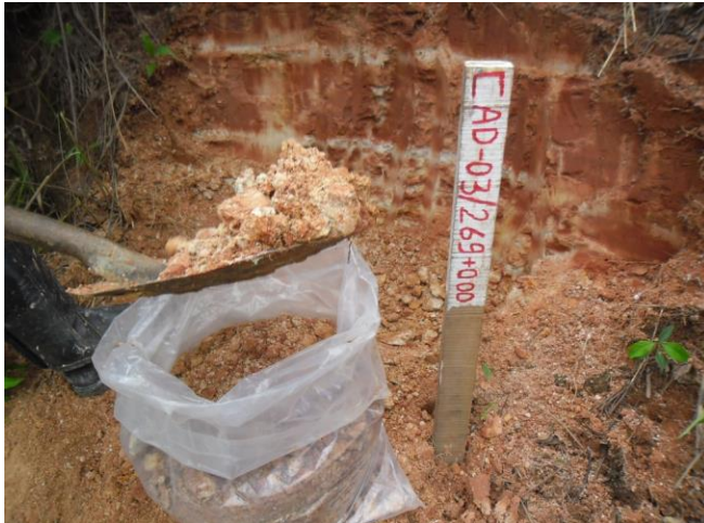
Figura 3 - Coleta de amostra deformada
