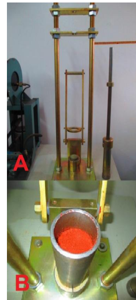
Figura 6. A: Aparelho de compactação utilizado no ensaio M5. B: Corpo de prova compactado
