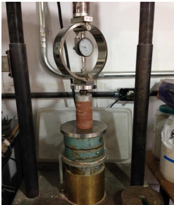
Figura 3. Ensaio de resistência à compressão simples
