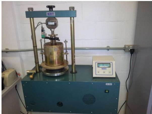
Figura 3. Corpo de prova submetido à etapa de penetração
