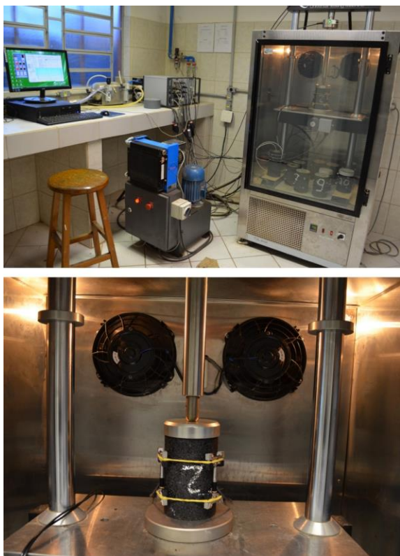
Figura 8 - Ensaio de módulo complexo
