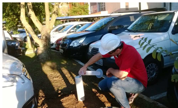
Figura 7. Execução dos ensaios de condutividade hidráulica (carga constante)
