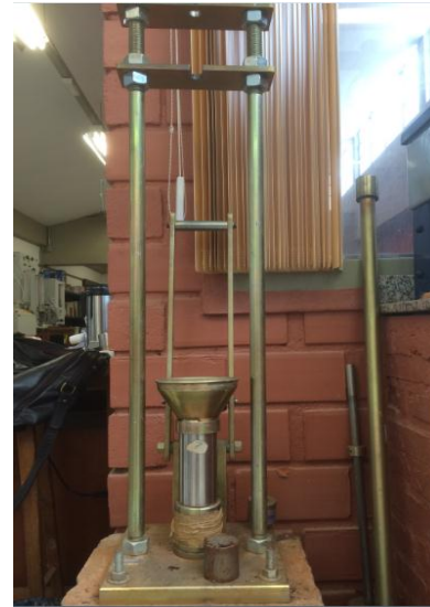
Figura 3. Equipamento para compactação miniatura
