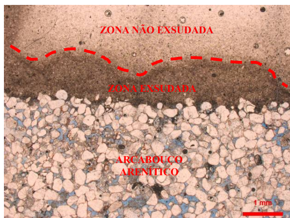
Figura 15. Lâmina 06, luz natural: diferença de tonalidade indica a zona de exsudação da nata.
