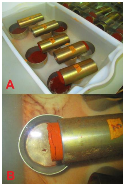
Figura 7. A: Corpos de prova imersos em tanque para ensaio M8. B: Detalhe do ensaio
