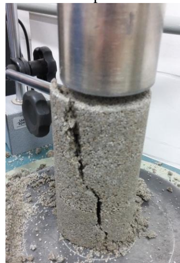
Figura 3. Ensaio de resistência à compressão simples
