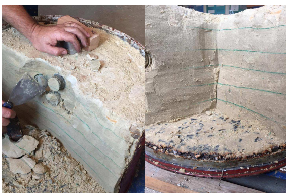
Figura 6. Exumação do CP_03Biocimentado.
