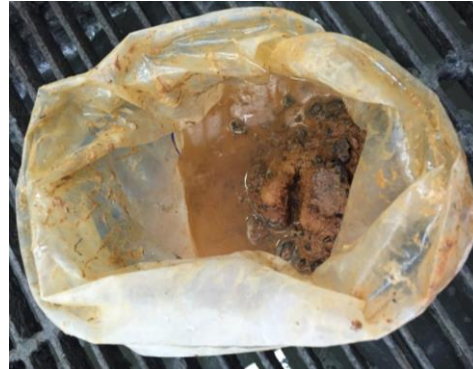
Figura 3. Corpo de prova com SL desagregado após cura úmida
