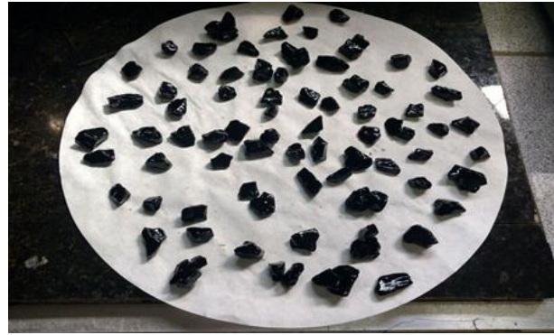
Figura 3. Ensaio de adesividade.
