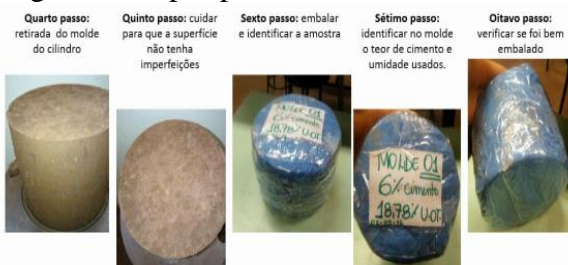
Figura 3. Etapas processo de ensaio de RCS
