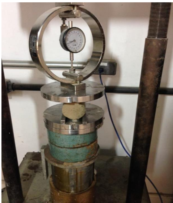
Figura 4. Ensaio de resistência à compressão diametral
