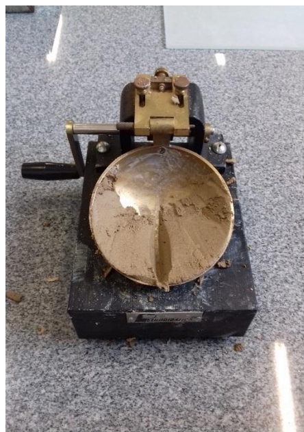
Figura 3 – Aparelho de Casagrande.
