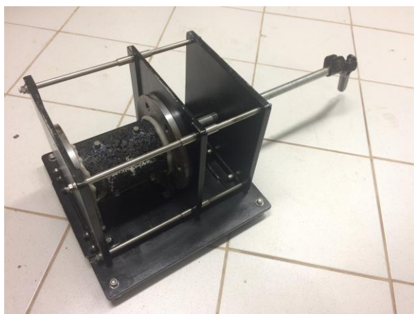
Figura 5. Sistema de colagem do corpo de prova e placas de colagem
