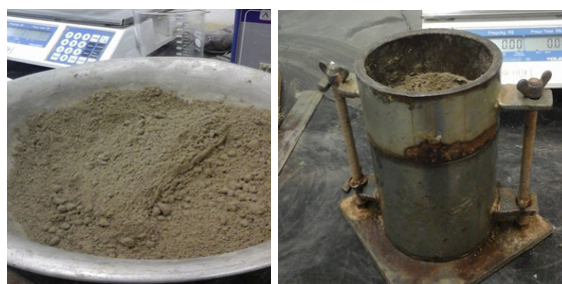
Figura 5. Ensaio de compactação segundo ABNT NBR 12023/12
