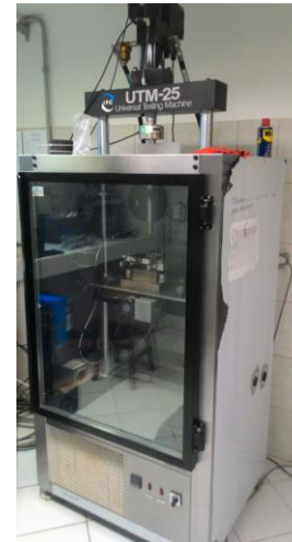
Figura 5. Prensa UTM-25 disponível no LMCC da UFSM.
