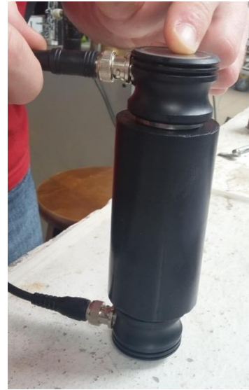
Figura 3. Medição de velocidade das ondas cisalhantes
