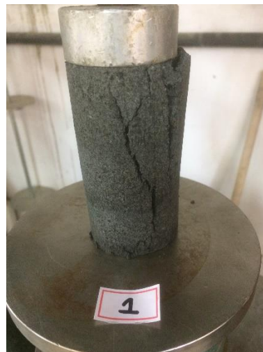
Figura 4. Corpo de prova de cinza pesada rompido à compressão simples
