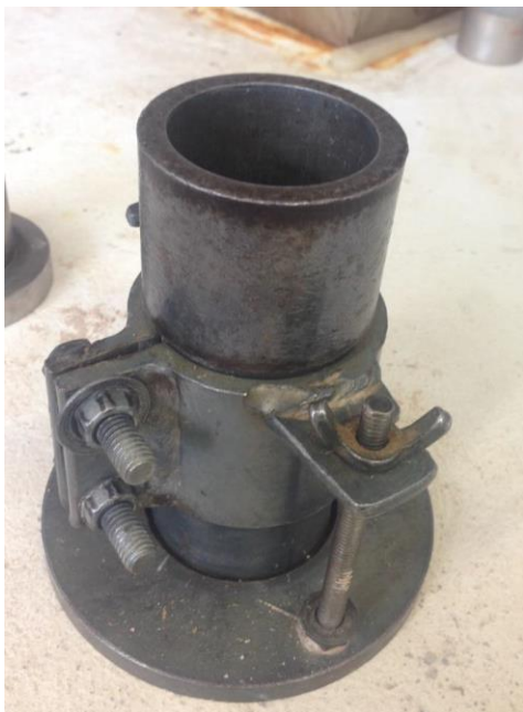
Figura 2. Molde metálico tripartido montado
