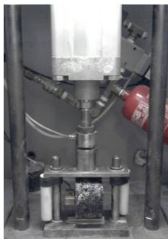
Figura 4: Equipamento para ensaio de Módulo de Resiliência.
