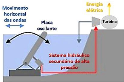
Figura 1: Princípio de funcionamento de um OWSC (adaptado de BELYAKOV, 2019).
