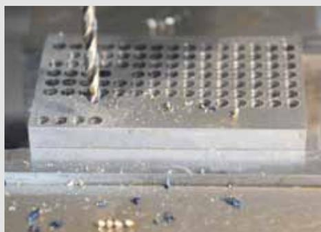
*Entre os testes realizados, está a repetição de furação de peças para testagem de materiais*
