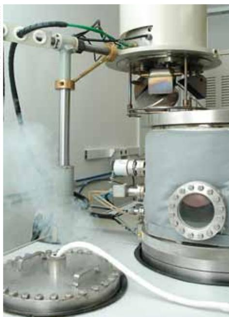
*Equipamento ion plating, usado para depositar revestimentos protetores, localizado no Laboratório de Engenharia de Superfícies*
