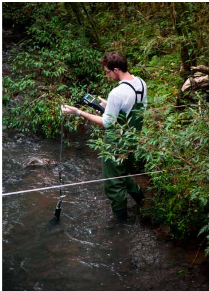
Aluno de Engenharia Química, Gregori Guerra, na coleta e medição de vazão da água do Arroio Samuara, em Caxias do Sul
